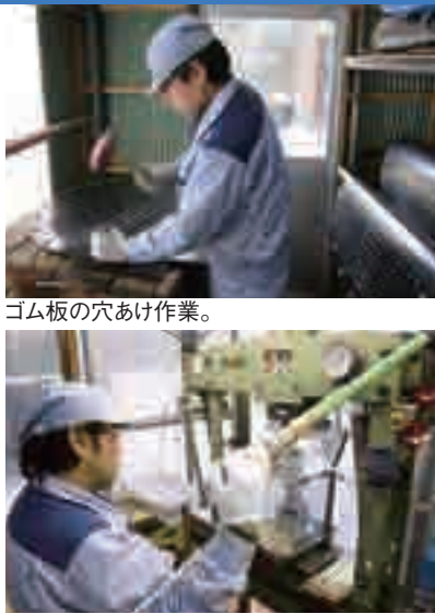
ゴム板の穴あけ作業。
