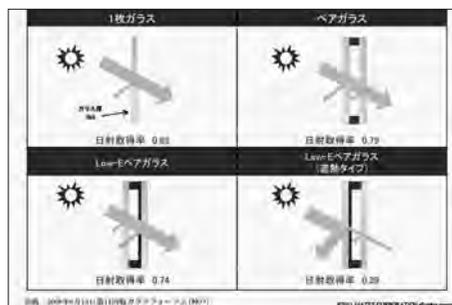
図07 窓ガラスの遮熱性能
