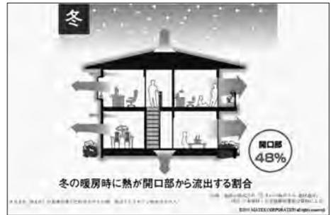
図03 冬の暖房時に熱が開口部から流出する割合
