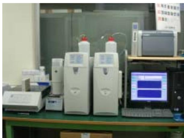
とにより、種々のイオン成分を分離するもので、溶出時間から定性を、ピーク面積から定量を行うことができます。本装置は、より高感度に測定するためのサプレッサを備えた機種です。
