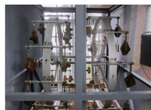
写真2 腐食促進試験
