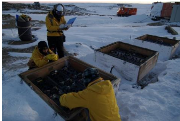
写真2：西オングル島でバッテリーの比重を計る様子
