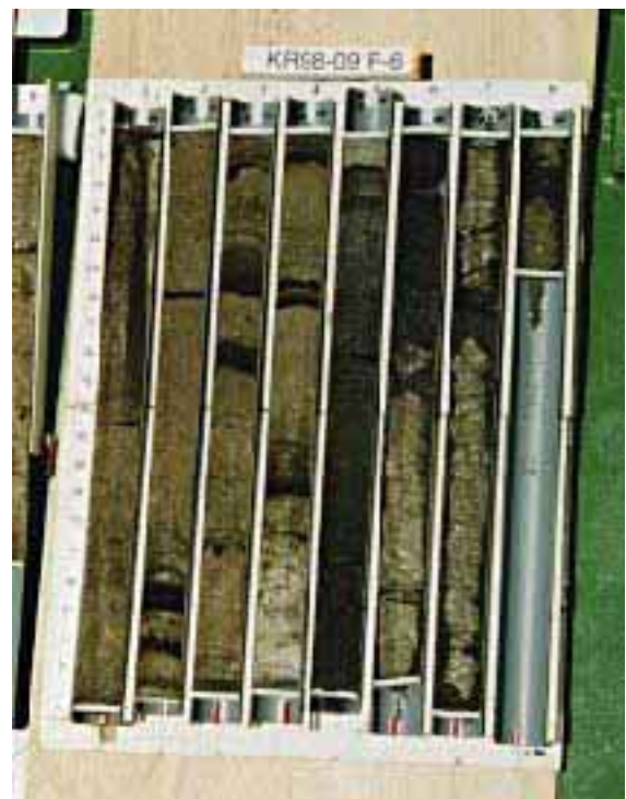
写真11 ハワイ島南方約80km(水深約5200m)で採取したピストンコア。ハワイ島の火山起源と考えられる黒色の火山砂層が複数認められる。
