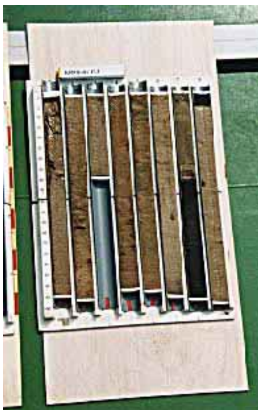
写真5 オアフ島北東方約200km(水深約4300m)で採取したピストンコア(P3)。恐らく Nuuanu slide起源と見られる黒色の火山砂層が含まれている。 Photo.5 Piston core sample from 200km northeast of island of Oahu (4300m), which is mostly composed of pelagic brown clay and black colored volcanic sand layer.
