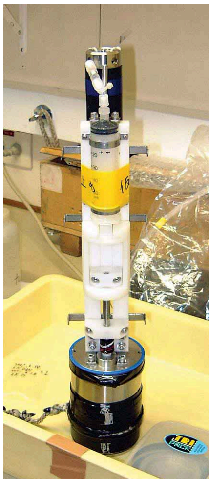
写真1 微量熱水採取器 (自己記録式温度計と組み合わせての使用例) Photo 1 A syringe type fluid sampler with a temperature recorder
