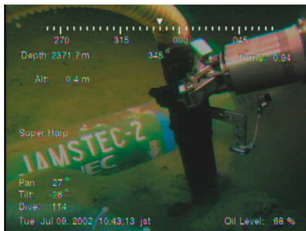
写真1 開発された地震埋設装置による掘削作業
