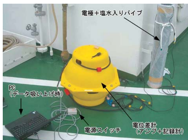
写真1 海底電位差計(中央)を用いた電極安定試験の様子 Photo 1 Ocean bottom Electrometer (or voltmeter: center) at the stability test for electrodes.
