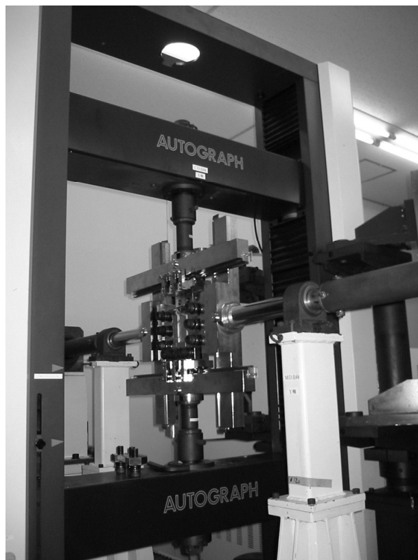
写真-1 二軸引張試験装置（所有：大阪府立産業技術総合研究所）
