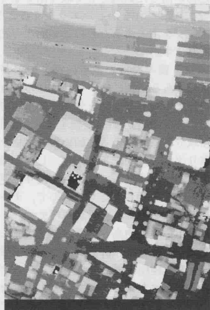
図-2 高さデータより作成された段彩図。白いほど高さが高い。黒い部分はデータ欠測部分
