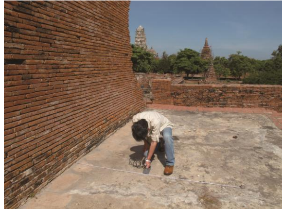
撥水処理効果の確認のための水分量の計測 (タイ・アユタヤ遺跡)
