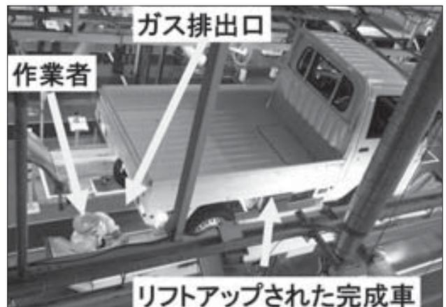
職場上長は、「足回りをチェックしながら、電気系統のチェックも行うので、エンジンonでの作業となる」、「足回り検査は工程として、車の下に移動して作業をせざるを得ない」、「作業改善の方策として、作業時間の短縮は困難」とのことであった。産業医は衛生管理者とともに作業改善の方策を検討した。排気ガス直下での作業が外せないのであれば、排気口に局所排気用の排気用ダクトを取り付けることや、排ガス口に排ガス量軽減のキャップを取り付けることを衛生管理者より現場上長に提案したが、作業工数が多くかかることや作業性が悪化することが懸念され、当初はばく露低減が困難と考えられた。産業医としては、排気ガス直下での作業は、基本的にエンジンonの状態でのばく露低減は難しいため、電気系統のチェックと足回りのチェック工程を切り離して、エンジンoffの状態で作業ができないか検討してもらうこととした。
