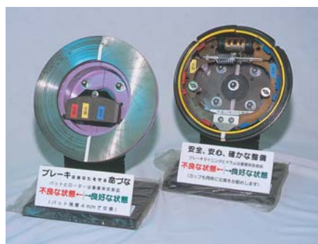
一目でブレーキの危険度が分かる特許申請中のディスクブレイ(左ディスク・右ドラム方式)。
