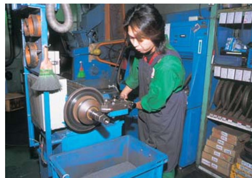
パッドの相方ともいうべきブレーキ・ローターの研磨。工作機械は同社の独自開発品で市販もされている。
