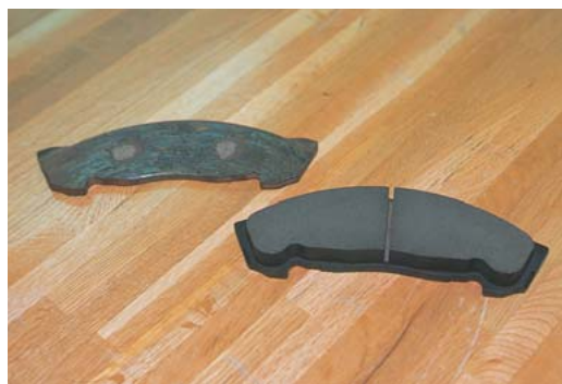
右が再生後に製品化されたディスクブレーキのパッド。左のように土台の金属まで磨耗させてしまうと著しく危険である。
