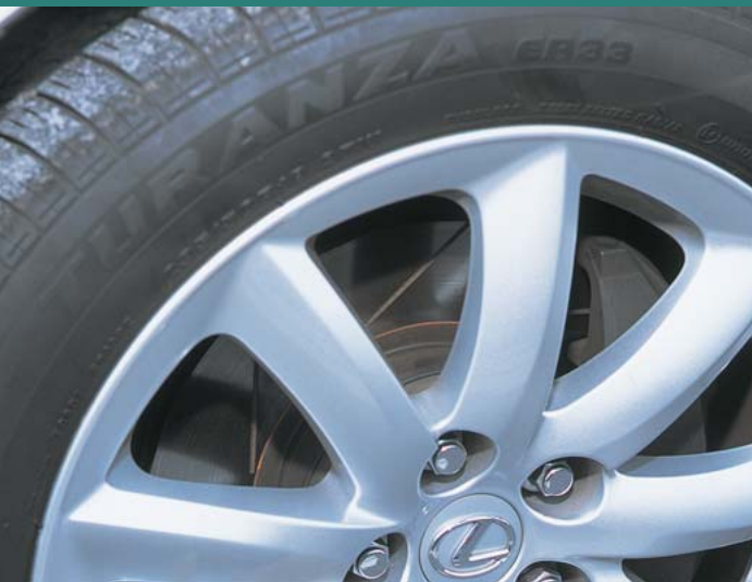
車輪のホイール越しに見えるディスクブレーキシステムの一部。風通しによる空冷効果は重要だが、駐車時の浸水には要注意。
