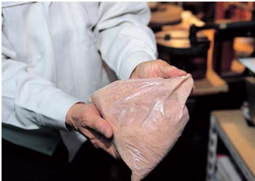
「昔は研磨剤として紅柄（ベンガラ：酸化鉄）を使っていましたが、最近は酸化セリウムが多いですね」
