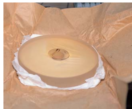
反射望遠鏡にはニュートン式やカセグレン式などが ある。後者の主鏡素材には中央部に穴が。
