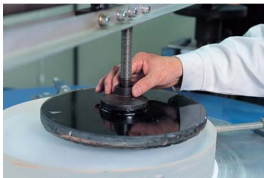
ピッチ盤と磨かれるガラスの接着面から伝わる微妙な滑りや 圧着抵抗を手で感じる。研磨音も刻々変化する。
