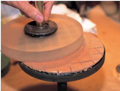
前ページのように格子状に溝切りされたビッチ盤の上に筆で研磨剤を塗り、ガラスを磨く。
