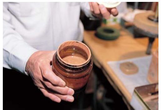
酸化セリウムの粉末を水と混ぜて研磨剤とするが、粒度は少なくとも6段階以上に調整して使う。
