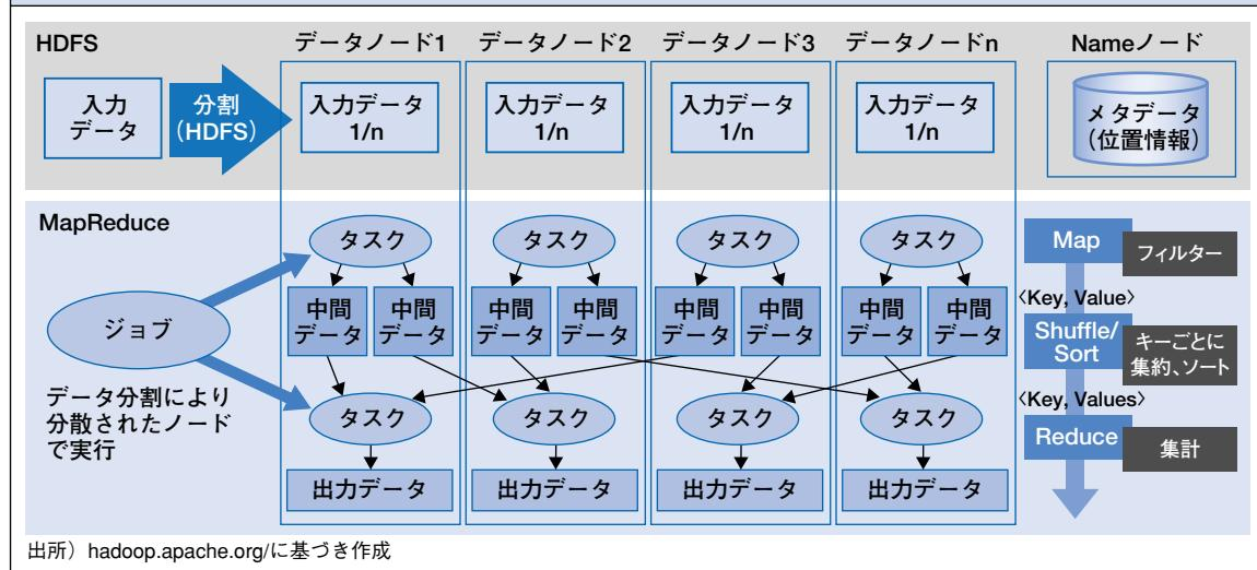
散する仕組み（プロセスグリッド）、HDFSがデータを分散する仕組み（データグリッド）となっており、2つの仕組みが連動することでスケールアウト可能な分散処理機能が実現されている。
