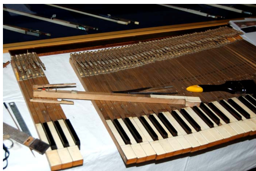
鍵盤全体をケースから出した鍵盤先端部
