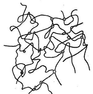
図4・1 加硫ゴムの理想的網状構造 図4・2 加硫ゴムの実際の網状構造
