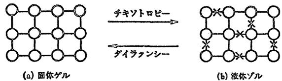
図2・16 分子、粒子の二次結合による網状構造とダイラタンシー、チキソトロピー
