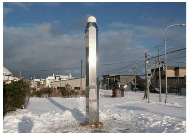
写真3 電子基準点「稚内3」
