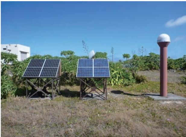
写真1 電子基準点「南鳥島」
