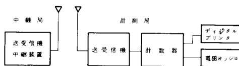
図1a KM-765A型船舶速度測定装置の系統図
