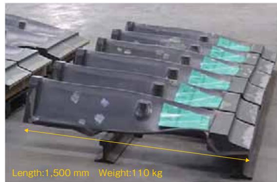
図4 超大型タービンブレード
