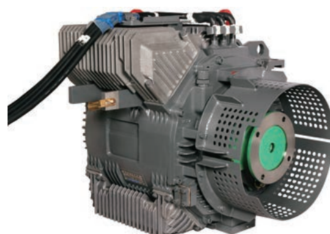
■ 全閉内扇式主電動機
