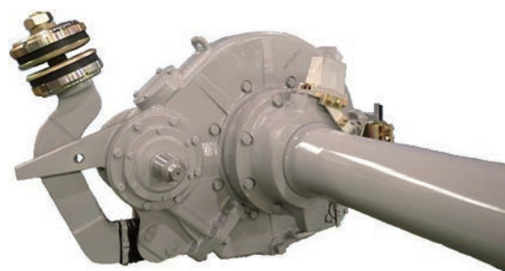
■ 電動貨車用駆動装置
