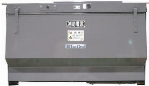
■ 図7 補助電源装置外観
