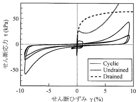
図-6 単調荷重と繰返し荷重の比較
