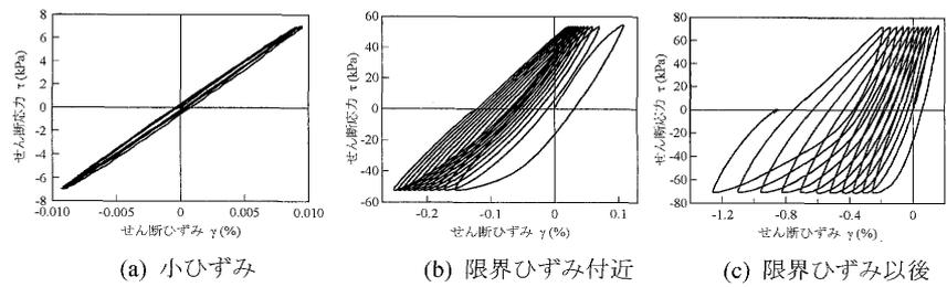
図二 繰返しせん断試験時の応力-ひずみ関係
