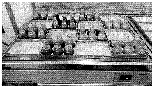
写真－１ ホットプレート法による気泡の除去状況
