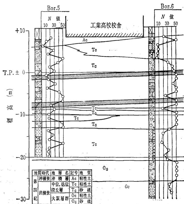
図-3 地質縦断面図
