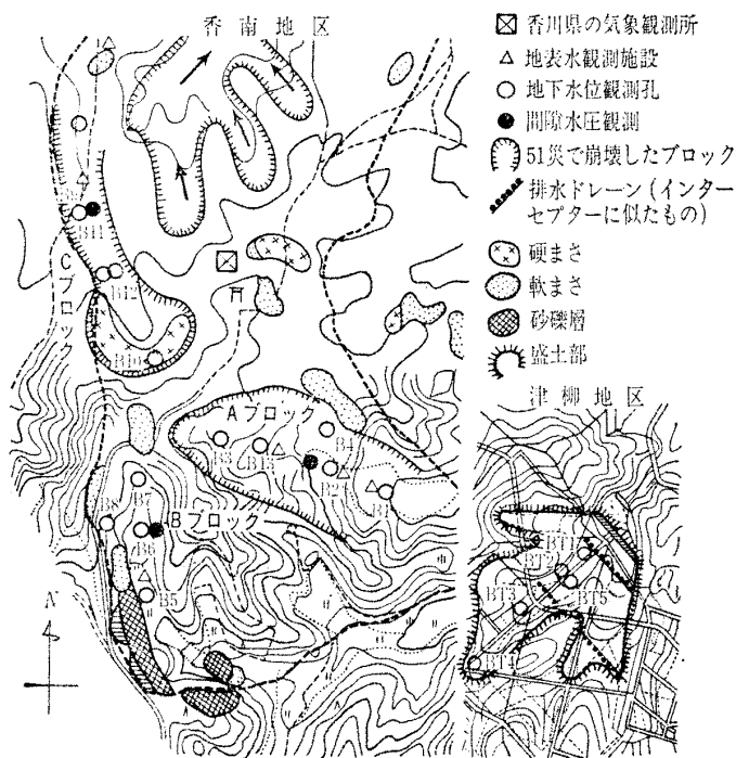
図-2 モデル調査地区の観測施設配置図
