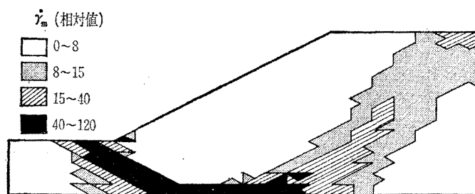
図—6 斜面が破壊する直前での \dot{\gamma}_m の分布図(粘性土地盤の砂盛土のケース)
