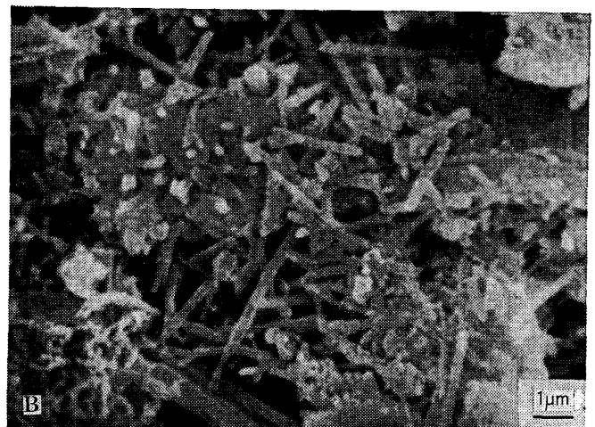
写真-3 粗骨材に接していたセメントペーストの組織
