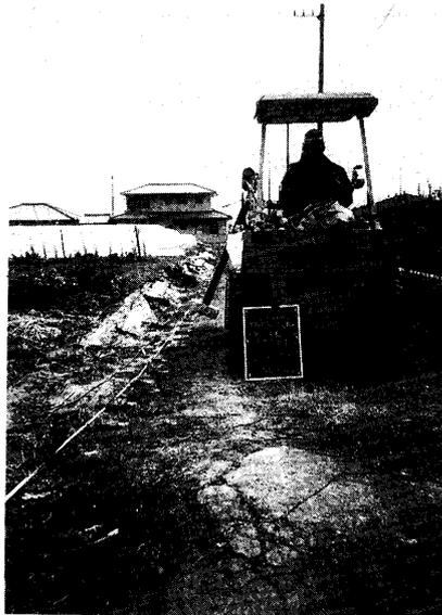
写真一 1 反射法地震探査の作業状況：メジャーテープに沿って地震計が等間隔に展開されている。
