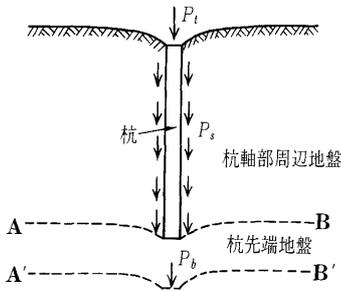
図-3.1 簡易モデルにおける地盤の変形<sup>3)</sup>
