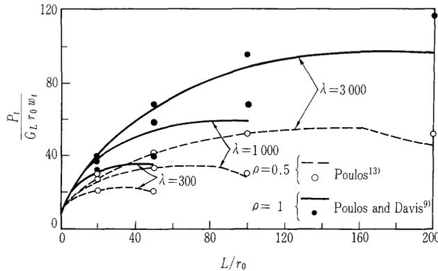
図—3.10 境界要素法と簡易モデルによる杭頭沈下剛性の比較<sup>6)</sup>
