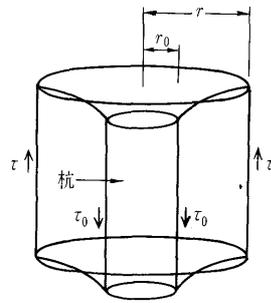
図-3.2 鉛直荷重を受ける杭周囲の地盤のせん断応力<sup>3)</sup>
