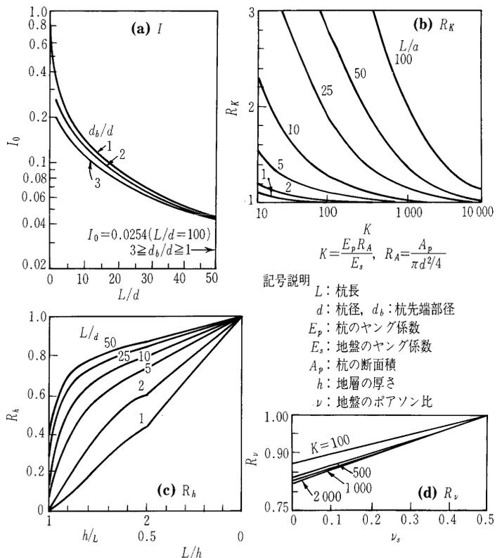
図-3.9 単杭の沈下影響係数<sup>9)</sup>
