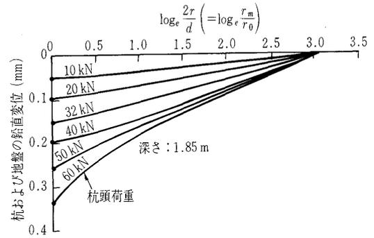
図-3.3 杭周囲地盤の沈下計測結果<sup>4)</sup>
