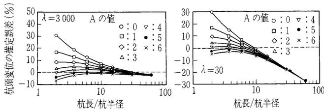
図—3.6 式(9)と式(12)によって算出した杭頭沈下量の推定誤差<sup>8)</sup>
