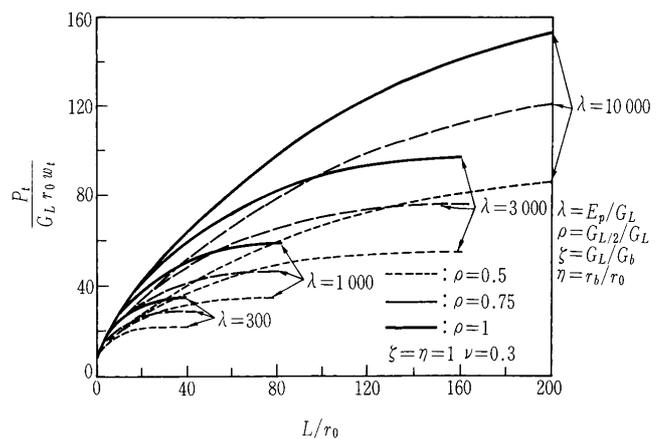
図-3.5 簡易モデルによる杭の沈下剛性<sup>6)</sup>
