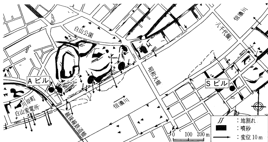
図—4.28 調査建物の位置と周辺の液状化被害
