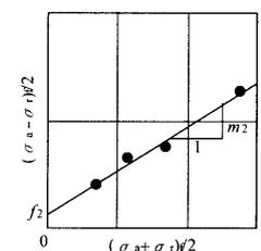
図一4  $c, \phi$  を求める方法 (方法2)
