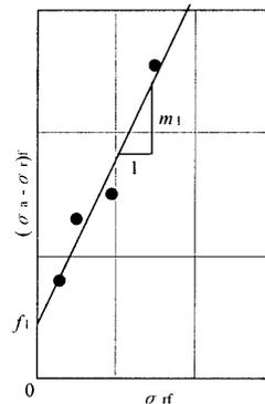
図一2  $c, \phi$  を求める方法 (方法1)
