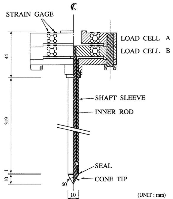
Fig. 2. Miniature cone penetrometer
