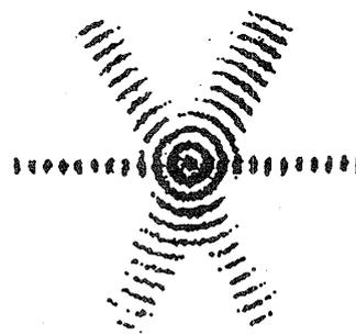
図2 トラップ中のイオンプラズマの結晶[4]。全体は殻状構造であり、3本のレーザー光に沿う部分だけが見えている。
