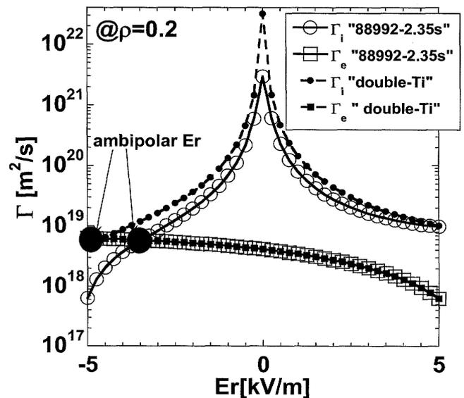
図 1 LHD 放電 (#88992, 2.35 s) の  $\rho = 0.2$  (白抜き印), その状況から  $T_i$  のみ 2 倍にした仮想状態 (塗りつぶし印) における新古典粒子束の径電場依存性. 丸 (四角) 印がイオン (電子) 拡散束を表す.
