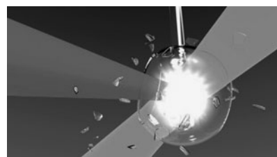
図1 GXII 2 ビームで対向爆縮し形成した重水素化ポリエチレン球殻のコアに直接 LFEX を照射すべく、CD 球殻の側面に開けた穴から LFEX を入射する模式図[1]。
