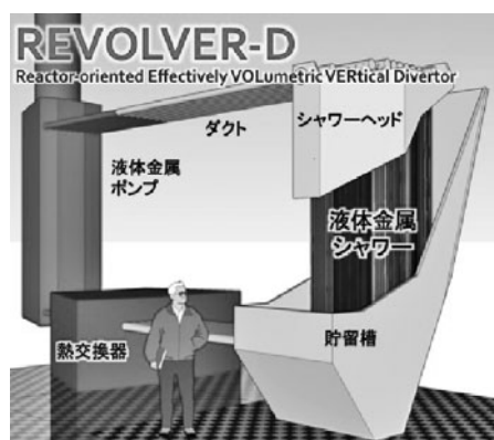
図7 REVOLVER-D ユニット概念図。
