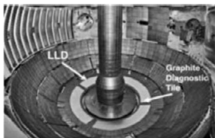
図1 NSTXに設置された液体リチウムダイバータ (LLD)[31]．
