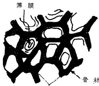
図3 フォーム材の内部構造
