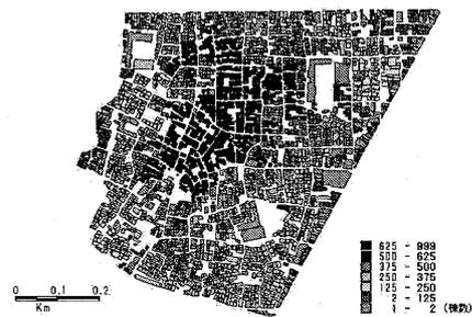
図4 建物単体データによるシミュレーション手法の限界(2)：地区内から1件出火するとし、すべての出火パターンについてシミュレーションを行い、3時間までの焼失棟数で出火建物を色分けした図である。こうした計算には、多大な計算時間を要する。
