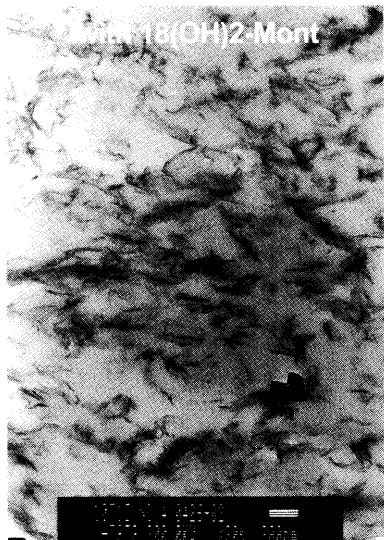
図3. ポリ乳酸とクレイのナノコンポジット化
