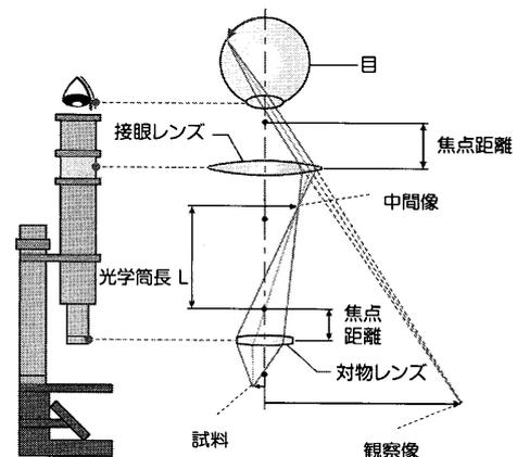
図2. 顕微鏡の原理
