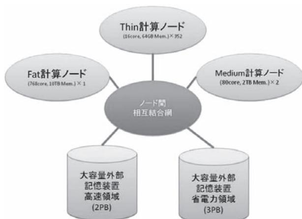
図3. 国立遺伝学研究所スーパーコンピュータ概要. システムは大別して三種類の計算ノードにて構成される. Thin計算ノードは64 GBメモリを搭載した通常のPCクラスターであり, Medium計算ノード(2台)は2 TB, Fat計算ノード(1台)は10 TBのメインメモリを搭載しており, 大量のメモリを要求するゲノムアセンブリなどの大規模塩基配列処理に特化した構成となっている.
