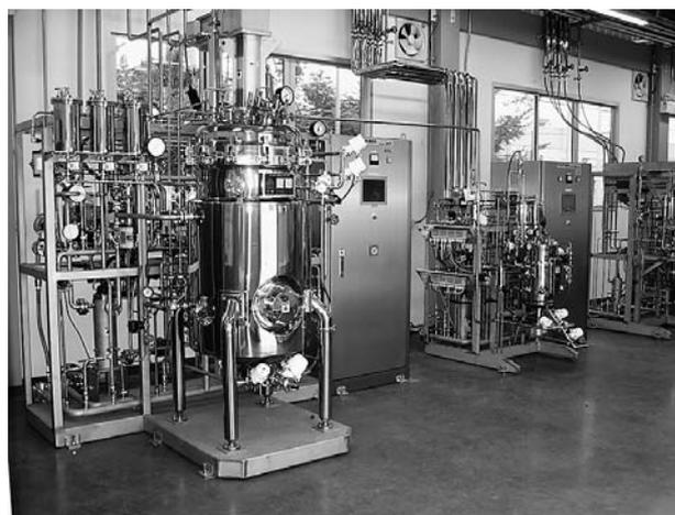
図2. 最近の標準的な培養装置 (30 L + 300 L)
