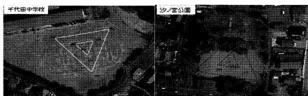
図-5 SPAC法による微動探査配置
