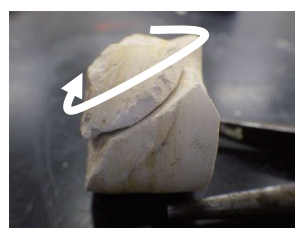
図 3a せん断試験片
