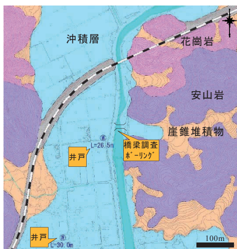
図 - 5 近傍のボーリング, 井戸による沖積層厚の推定
