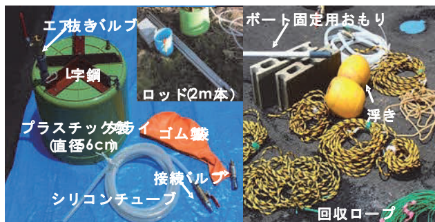
写真 2-1 製作した深水対応型 Seepage meter
