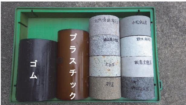
写真-2 物性値が既知の岩石等試料（右側2列は岩石試料）各試料の物性値を表-1に示す。
