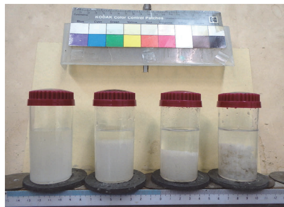
図-1 凝集剤による泥剤の分離状況
